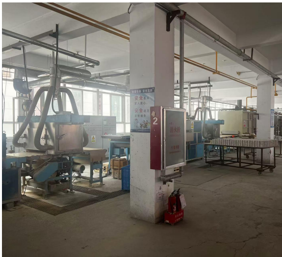
现有碳化硅泡沫陶瓷过滤器生产线
